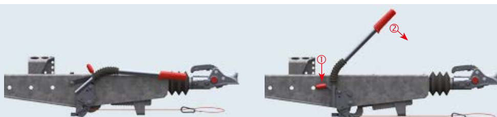
Рычаг ручного тормоза затянут = тормозная тяга натянута
